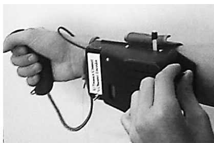
На руке крепится пульт с тумблерами управления каналами «Инкодер»
