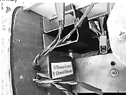
На борту приёмное устройство «Декодер»
